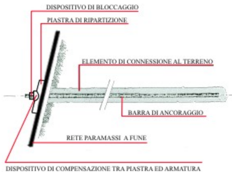
PARTICOLARE COSTRUTTIVO DI UN CHIODO DI ANCORAGGIO
